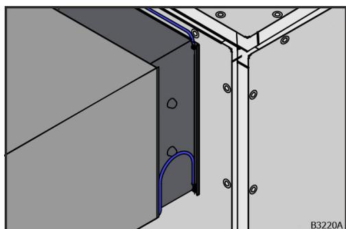
Fig. 28 : Conducteur de liaison équipotentielle sur le registre
