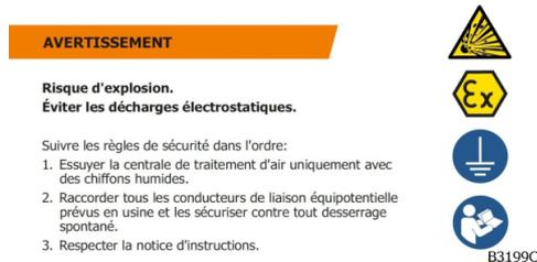
Fig. 6 : avertissement « Risque d'explosion. Éviter les décharges électrostatiques. »
