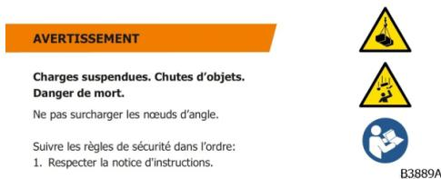
Fig. 8 : avertissement « Charges suspendues. Chute d'objets. Danger de mort. »
