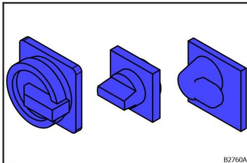
Fig. 11 : Interrupteur d'arrêt
