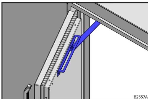
Fig. 12 : Mécanisme de blocage de porte
