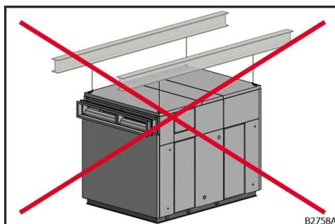
Fig. 20: Installation incorrecte
