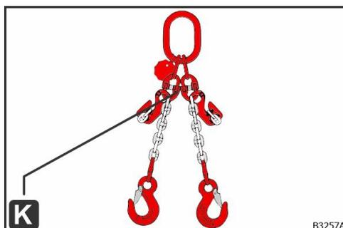
Mit der 2-strängigen Anschlagkette (K) wird die Last angeschlagen. Diese umfasst auch einen Kettenverkürzungshaken.
