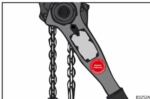
Fig. 49 : Plaque de contrôle (palan à chaîne à levier)
