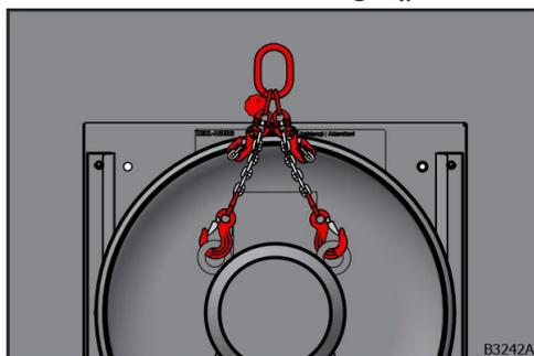
Fig. 32 : accrochage des chaînes d'élingage avec deux anneaux de butée
