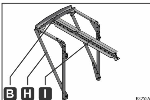
Fig. 55 : Pièces à monter par le client
