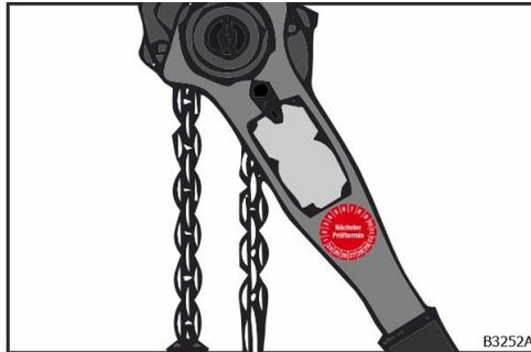
Abb. 122: Prüfplakette (Hebelkettenzug)
