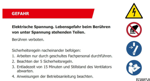
Obr. 2: Nebezpečenstvo „Elektrické napätie. Nebezpečenstvo ohrozenia života pri kontakte s dielmi pod napätím.“
