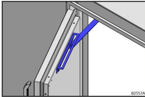
Abb. 12: Türfeststellvorrichtung
