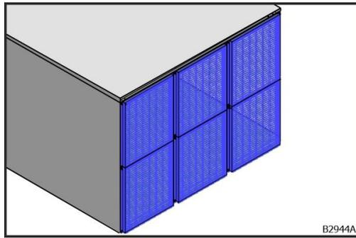
Ein Berührungsschutzgitter ist an den Luftöffnungen am Geräteanfang oder Geräteende angebracht, wenn diese nicht mit Geräteanschlüssen, Wetterschutzvorrichtungen oder Ähnlichem versehen sind. Das Berührungsschutzgitter verhindert Verletzungen durch das unbeabsichtigte Berühren von Komponenten am Geräteanfang oder Geräteende.
