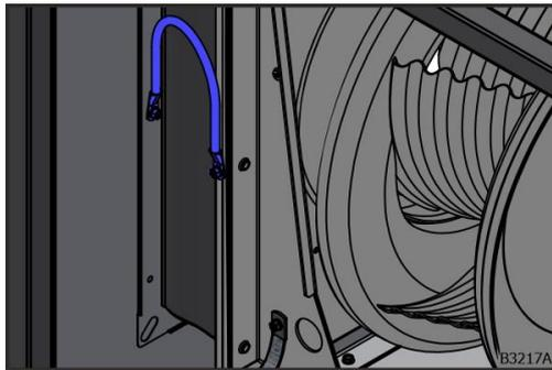
Abb. 31: Potentialausgleichsleiter am flexiblen Stützen des Ventilators
