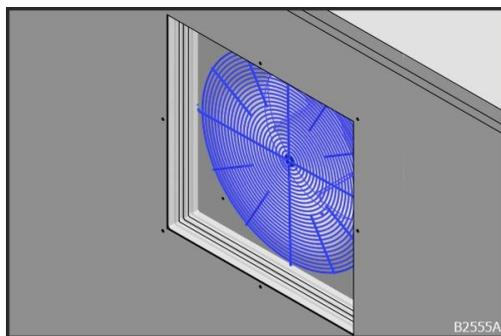
Abb. 19: Ansaugschutzgitter
