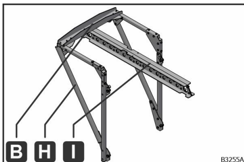
Obr. 40: Diely, ktoré sa namontujú na stavbe
