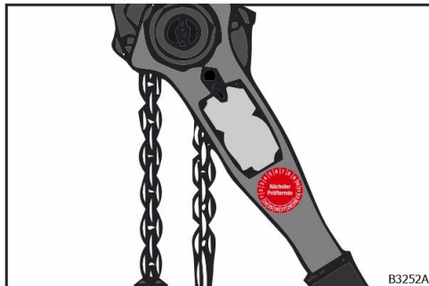
Obr. 34: Kontrolná nálepka (pákový reťazový kladkostroj)
