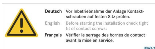
Obr. 4: Výstražný štítok „Kontrola kontaktných skrutiek“
